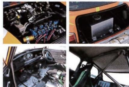
エンジンはクランク、コンロッドの軽量化バランス取りをし、ピストンはスズキスイフト用を使用。1293ccのヘッドはポート研磨をし、圧縮比は10.5に。安全燃料タンクは37L。タカタのベルトにブリッドのシートを装備。
