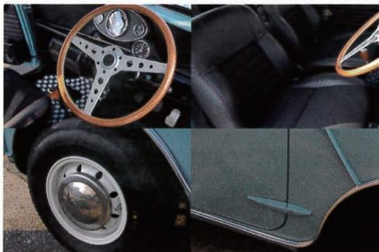
インテリアは純正シートをレザーとファブリックのコンビで張り替え、ステアリングはモモのモンツァを装着。ドアは角丸に加工されているが、アウターヒンジはダミーだ。耐久性を考えて、オーナーと辻代表が相談して決めたことである。夏の使用を考えて、吊り下げ式のクーラーも装着。
