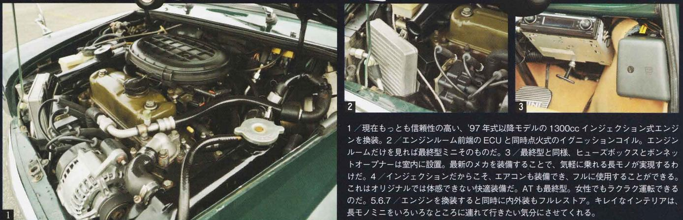
1／現在もっとも信頼性の高い、'97年式以降モデルの1300ccインジェクション式エンジンを換装。2／エンジンルーム前端のECUと同時点火式のイグニッションコイル。エンジンルームだけを見れば最終型ミニそのものだ。3／最終型と同様、ヒューズボックスとボンネットオープナーは室内に設置。最新のメカを装備することで、気軽に乗れる長モノが実現するわけだ。4／インジェクションだからこそ、エアコンも装備でき、フルに使用することができる。これはオリジナルでは体感できない快適装備だ。ATも最終型。女性でもラクラク運転できるのだ。5.6.7／エンジンを換装すると同時に内外装もフルレストア。キレイなインテリアは、長モノミニをいろいろなところに連れて行きたい気分にさせてくれる。
